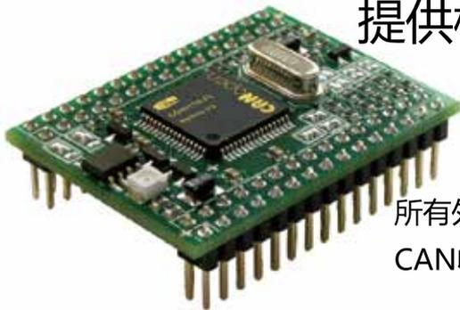
所有外设例如晶振、芯片复位和CAN收发器都集成在板子上。
