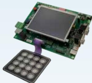
开发板，带TFT-LCD显示器和薄膜键盘
