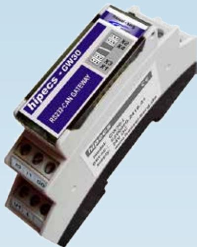
该模块能够集成接口为RS232的设备集成到CANopen网络，非常方便。该网关使用简单的串行数据流并直接转换数据流成CANopen协议。对于基于串行接口的设备，该协议完全透明，无需专用的网关协议。该功能保证，现有的硬件可连接CAN网络，以及新部件。串行通讯参数可从CAN总线端设置。该网关支持波特率达到460,800 baud。免费的可编程预定标器支持不常用的波特率，以及标准波特率。
